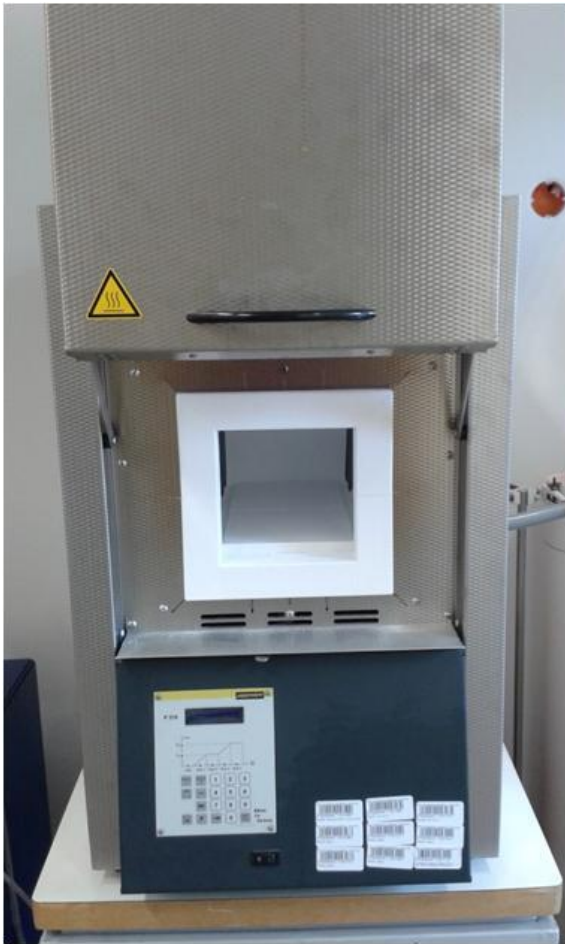
Nabotherm izzítókemence (max. 1800 °C)
